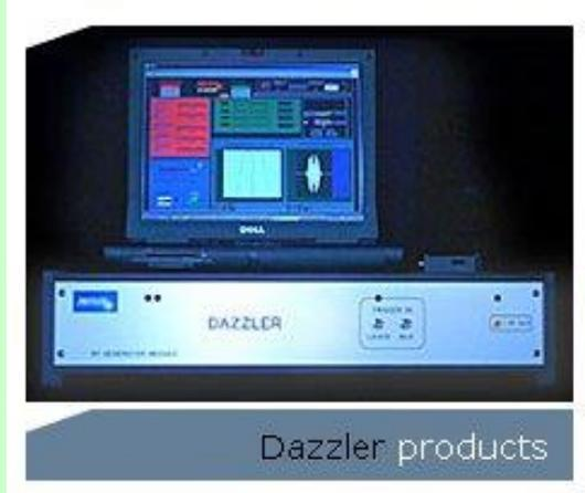
Dazzler : instrument de mise en forme d'impulsions laser.
