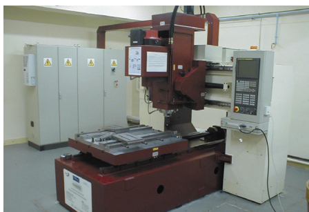
1- Soudage par friction malaxage
