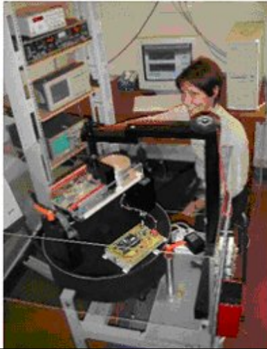
Essais d'un gyromètre à effet Sagnac
